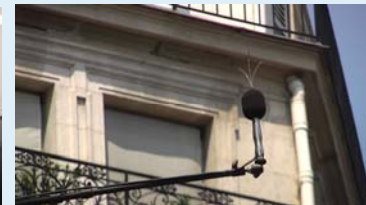
Microphone à 2 m d'une façade
