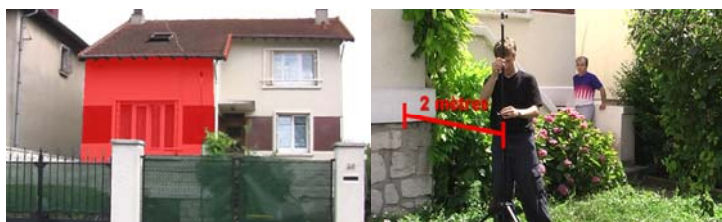
Installation du matériel de mesure chez un riverain à 2 mètres en avant de la façade la plus exposée
